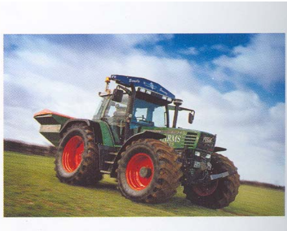
Şekil 9. Traktöre monte edilmiş azot algılayıcı ve aynı anda gübreleme yapabilen sistem (Anonymous, 1998)
